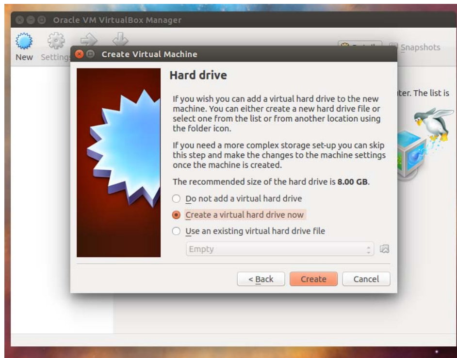
Slika 5.1.4. Kreiranje virtuelne particije za skladištenje podataka na virtuelnoj mašini
