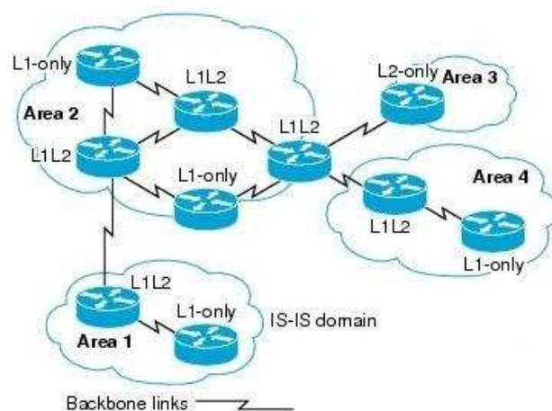
U ovom radu je obrađen IS-IS (Intermediate System to Intermediate System) protokol, kako teorijska osnova, tako i simulacija jednostavne mreže konfigurisane ovim protokolom. Za potrebe simulacije korišćen je softverski alat GNS3 (Graphical Network Simulator 3). Ovaj rad daće Vam uvid u tipove protokola rutiranja, paketa koji se koriste u IS-IS protokolu i osposobiće Vas da sami konfigurirate rutere i vršite simulacije Vaših mreža.
