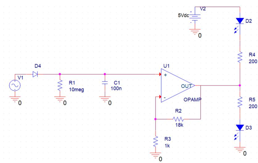
Kolo sa slike služi da prevede analogni signal sa stereo izlaza uređaja u digitalni indikator.
